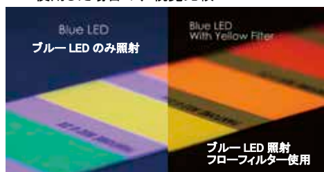
455nm Blue LED 照射とフローフィルターを使用した場合の、視覚比較
