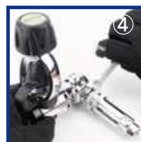
④ レンチを使ってエアフィルターを緩まない様に取付ける
